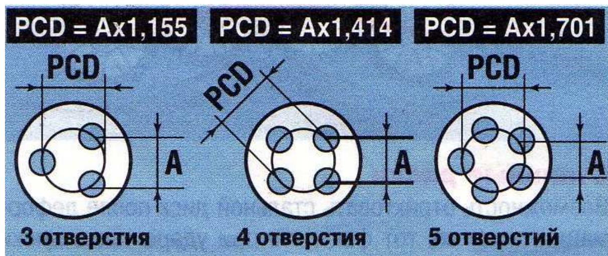
Рисунок 2.26 – Формула расчета PCD по расстоянию между центрами отверстий (A)
