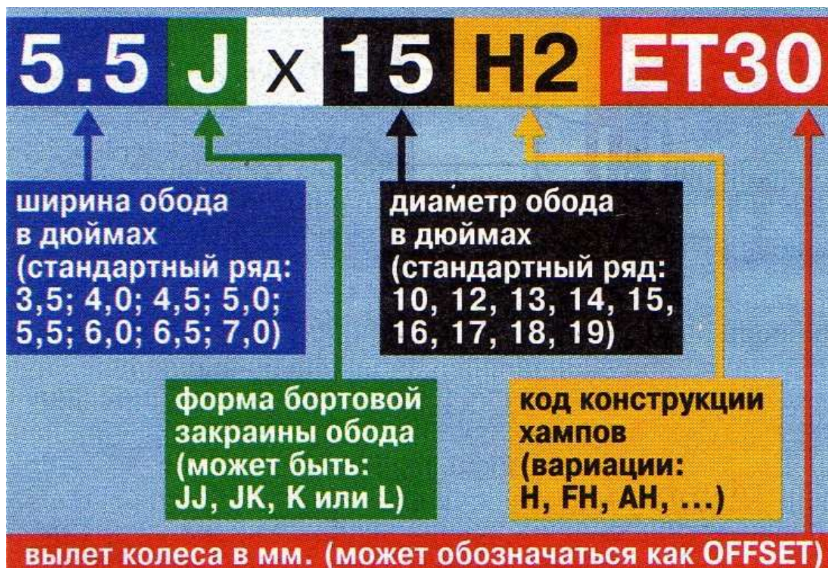
Рисунок 2.20 – Характеристика дискового колеса легкового автомобиля
